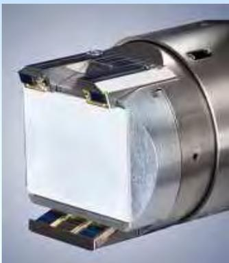
Halbleiter-Dioden als RE-Detektoren
